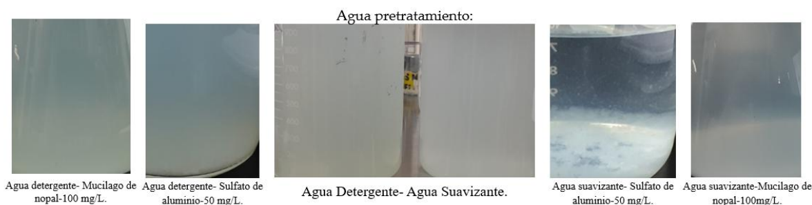
Figura 4.-Efecto de los coagulantes en el tratamiento de aguas residuales: Dosis óptima de los coagulantes con mayor eficiencia.
