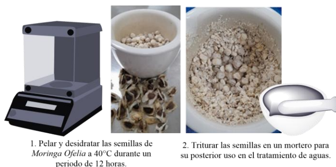
Figura 3.-Proceso de preparación: Semilla de Moringa oleífera para su uso como coagulante.
